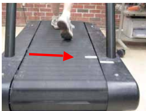
Figure B-2 : La vérification de la vitesse du tapis roulant nécessite un chronométrage précis du nombre de tours qu'effectue le tapis en un temps donné. Il faut remarquer le moment où le repère en ruban sur le tapis s'approche du repère sur le cadre du tapis roulant. Chaque fois que le ruban passe vis-à-vis du repère sur le cadre, le tapis a fait un tour complet. Consultez le texte pour plus de détails. Il est essentiel qu'une personne marche sur le tapis pendant la vérification de sa vitesse.
